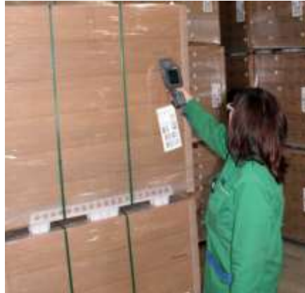
Lote de piezas de mobiliario identificadas con un tag RFID Fuente: (Swedberg, 2010).
