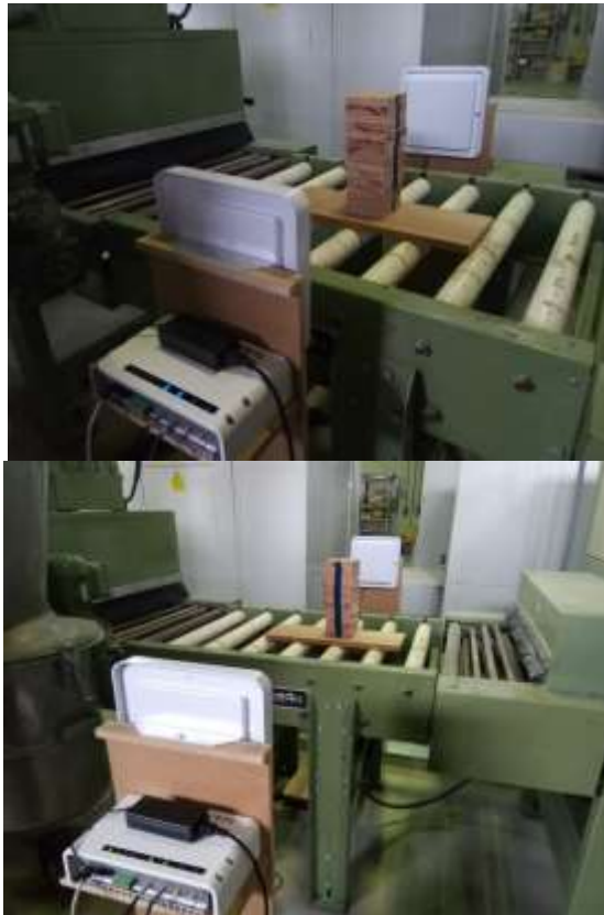
Ejemplo de lecturas realizadas con dos antenas configuradas en modo arco
