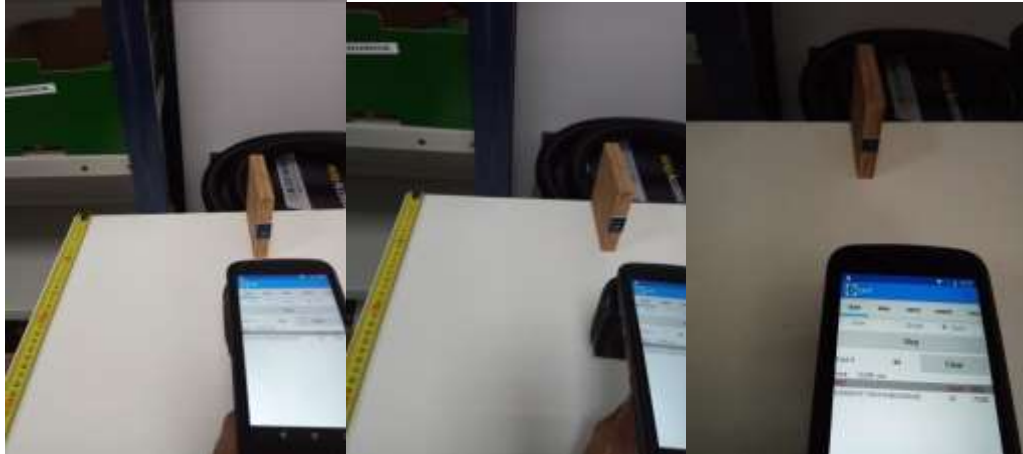
Medición del alcance de lectura de cada modelo de tag
