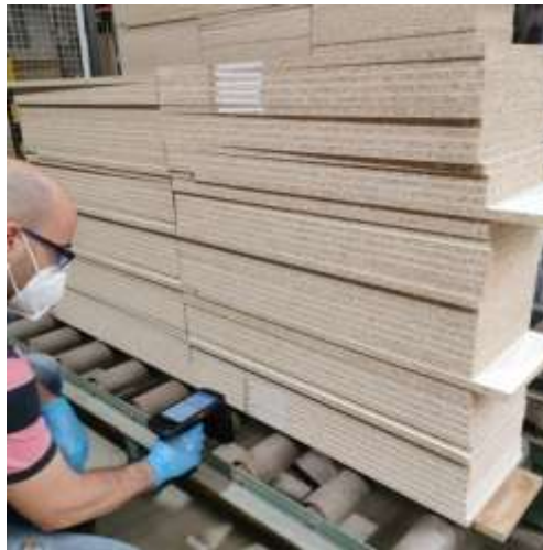
Lectura de etiquetas modelo A y B a la salida de la seccionadora.
