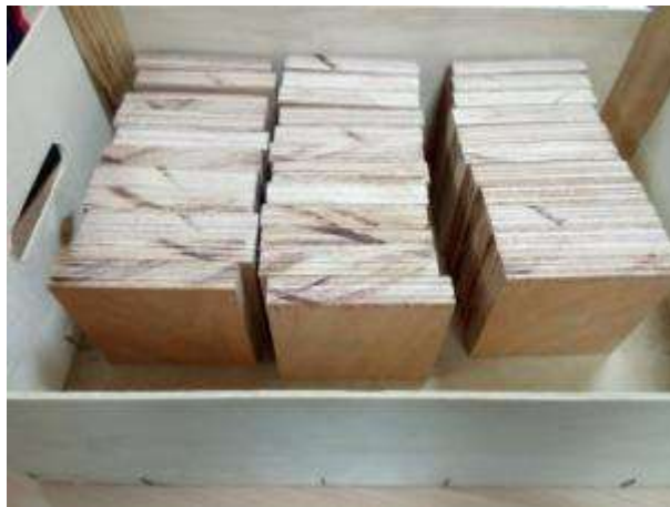
Imagen de las probetas colocadas en la orientación vertical. Fuente: Fotografía tomada por AIDIMME.
