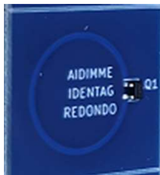
Detalle de la PCB con la antena circular de 5,86 mm de radio (tamaño real de la placa 16 mm x 18 mm)
