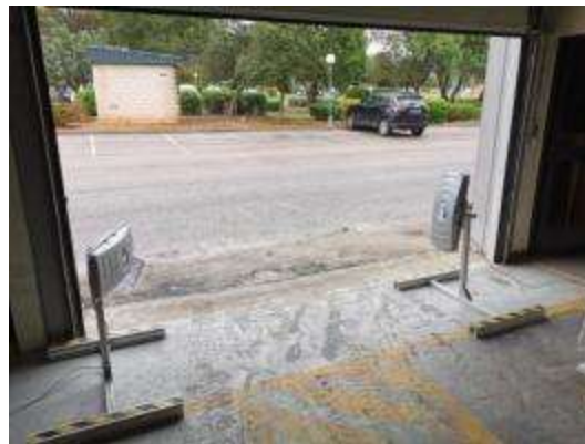
Imagen de las antenas ubicadas en modo arco. Fuente: Fotografía tomada por AIDIMME.
