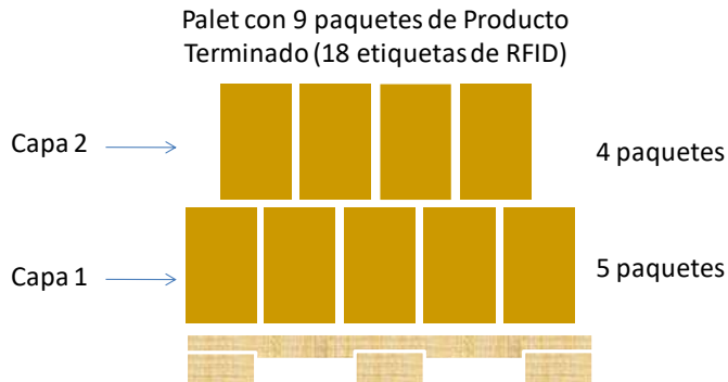
Esquema del palet y ubicación de etiquetas RFID..
